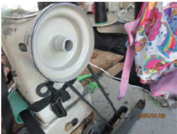
NC-No pulley guard equipped.JPG
