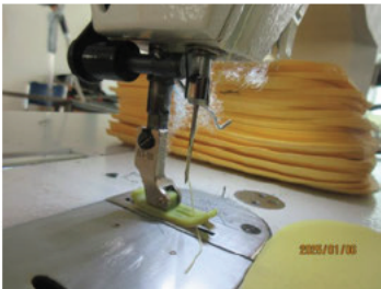
NC-No needle guard equipped.JPG
